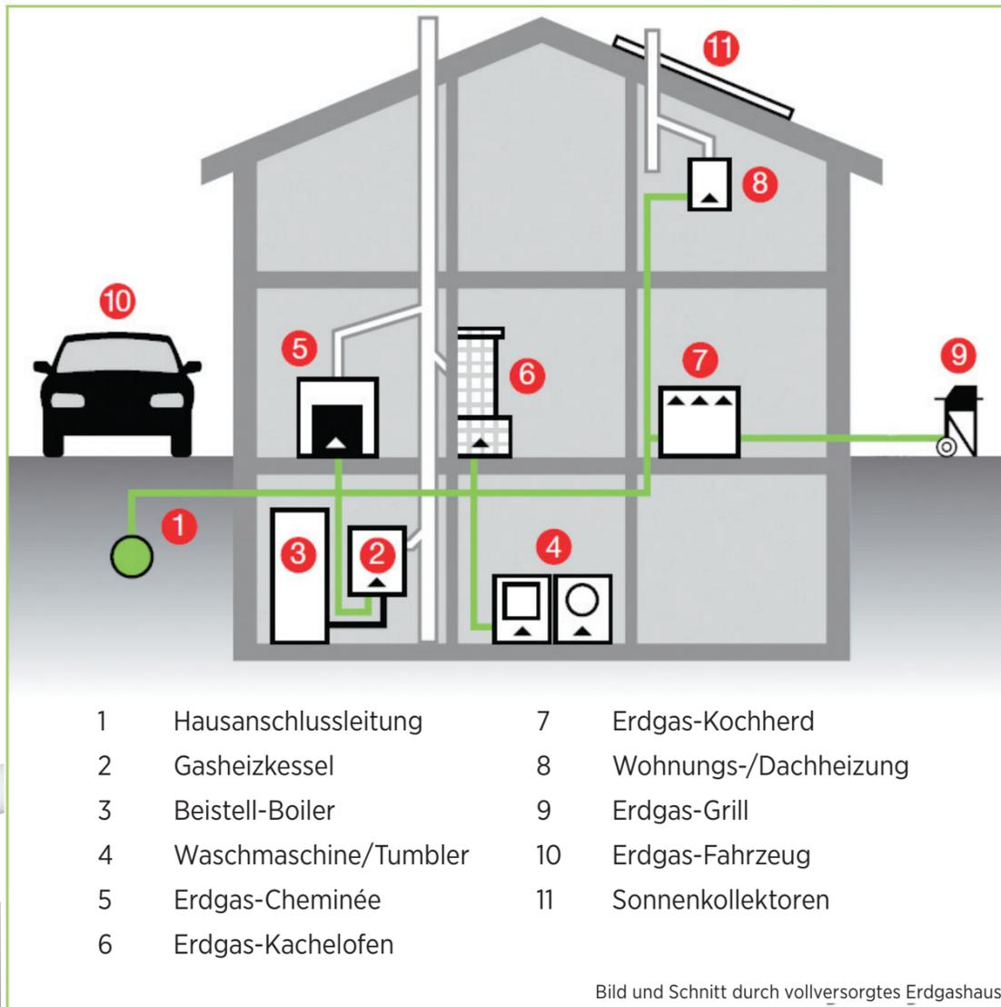
Bild und Schnitt durch vollversorgtes Erdgashaus
